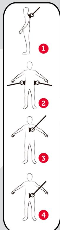
(1) La argolla dorsal se utiliza en sistema anticaídas o restrictivo, (2) las laterales para posicionamiento, (3) la esternal para uso con sistemas anticaídas verticales, (4) la argolla ventral puede utilizarse para sujetar un descensor, cintas de posicionamiento o cintas de progresión.
