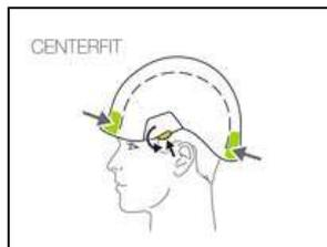
La regulación CENTERFIT ofrece un centrado perfecto del casco en la cabeza, gracias a las dos ruedas de regulación laterales.
